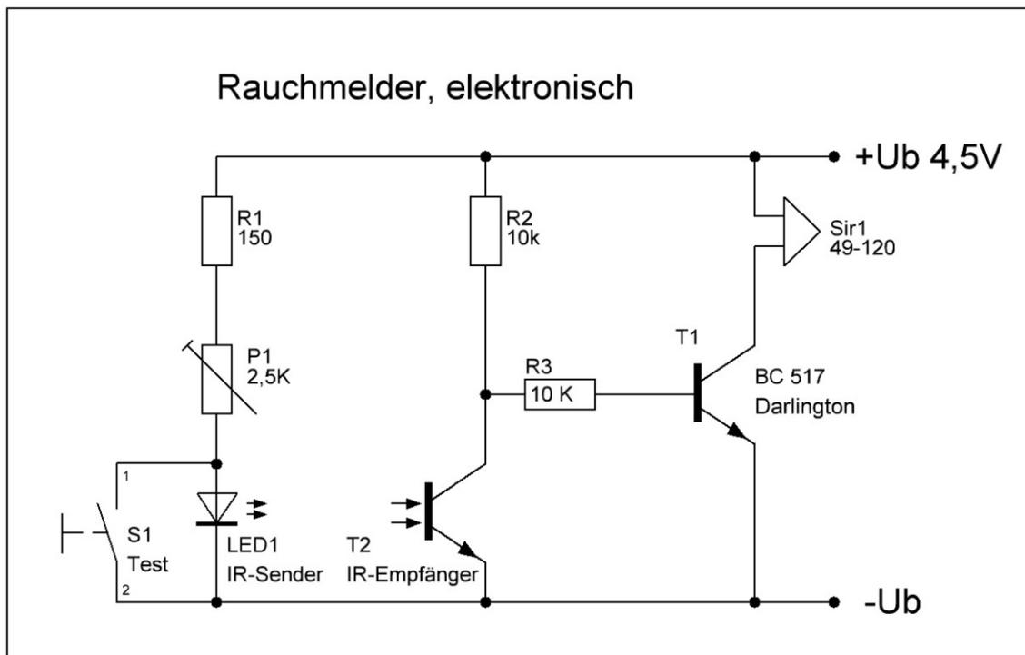
Diese Schaltung stellt das Prinzip eines Rauchmelders dar und verwendet 2 Sensoren (Taster S1) und IR-Empfänger, sowie einen Aktuator Sir 1. Dies kann z.B. ein Pulstonsummer (49-120) sein, aber auch eine LED oder Blink-LED mit entsprechendem Vorwiderstand (150 Ohm).
