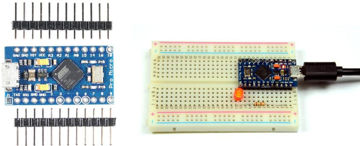
Der Pro Micro bietet auf kleinstem Raum einige Ein- und Ausgänge, Analog, Digital und Digital PWM. Er ist für den Unterricht optimal geeignet, da er günstig ist, optimale Features bietet und wie ein IC auf einem Steckboard/Breadboard eingesetzt werden kann. Seine USB-Funktionalität ermöglicht professionelle Anwendungen in unterschiedlichsten Bereichen. Die Programmierung entspricht der des Arduino Leonardo.
