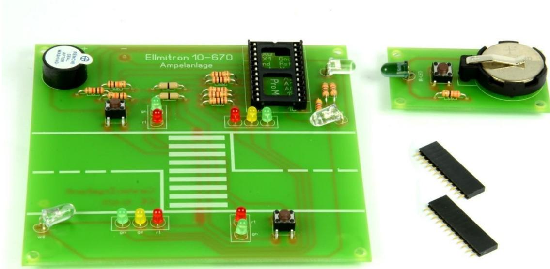
So sollte die fertige Platine Ampelsteuerung und die Platine IR-Sender aussehen. (Abb. incl. Erweiterungen)
