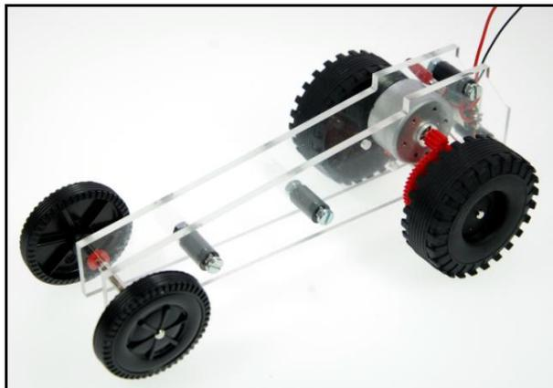
Aufbau mit Getriebe 5:1
