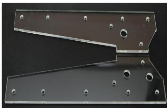
Die blaue Linie in der Zeichnung auf Seite 12 stellt die Außenkontur der beiden Seitenteile dar und kann mit einer Laubsäge gesägt oder mit einer CNC-Maschine gefräst werden. Bitte beachten Sie, dass ein fertiges CNC-Bohr-/Fräsprogramm auf unserer Homepage [www.ellmitron.de](http://www.ellmitron.de) verfügbar ist.
