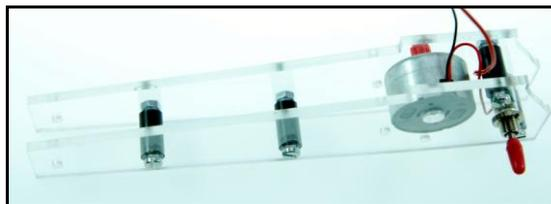
Bitte achten Sie darauf, dass der Schalter so eingebaut wird, dass der Schalthebel in Richtung der beiden oben und unten gelegenen, rechten Schrauben schaltet. Nur so bleibt genügend Platz zu den Antriebsrädern.
