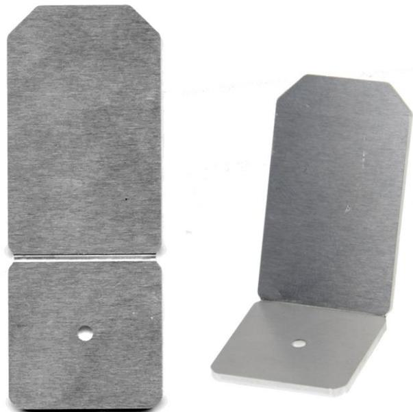
Entsprechend der Maßzeichnung wird der Fahrersitz aus dem Alublech 80 X 30 X 2 hergestellt. Übertragen Sie die Maße auf das Alublech und können Sie die Bohrung an.
