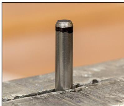
6. Den Rundstab spannen wir senkrecht in den Schraubstock mit Schutzbacken ein und feilen mit der Flachfeile die Fasse von 30°. Die Feinarbeit kann an der Bohrmaschine erfolgen.
