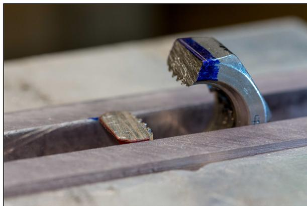
Wir versuchen, die Feile absolut waagrecht zu führen. Mit der einen Hand „schieben“ wir mit kurzen Hieben die Feile, während der Daumen der anderen Hand die Feile fest auf das Werkstück drückt. Durch die Leisten kann die Feile nicht kippen. So erreichen wir, dass eine plane Fläche entsteht.
