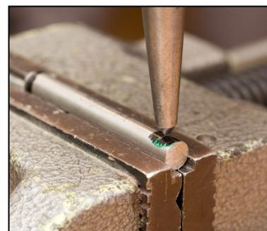
9. Wir bringen die Körnerspitze an den Schnittpunkt, stellen ihn senkrecht und körnen mit einem Hammerschlag. Diese Körnung sollte so tief sein, dass der Bohrer nicht verlaufen kann. s. Abb. oben
