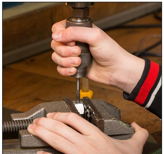
51. Wiederholt geben wir Bohröl an die Schneiden des Gewindebohrers.
