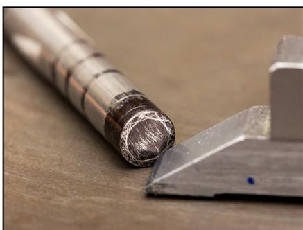
Nun legen wir den Rundstab auf die Richtplatte und reißen an der Stirnseite 1 mm an, bis aus den einzelnen Anrissen ein „Kreis“ von 6 mm Ø entsteht.
