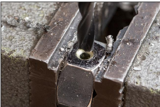
42. Zwischendurch führen wir den Senkhebel etwas zurück, dass die Späne abbrechen und kontrollieren die Bohrung. Dazwischen tragen wir mehrmals Bohröl an den Schneiden des Bohrers auf.
