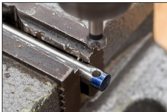
17. Das Ende des Rundstabs wird jetzt noch abgerundet. Nach der Bearbeitung mit der Feile am Schraubstock kann das Werkstück zur Feinbearbeitung in das Bohrfutter der Bohrmaschine eingespannt werden. Dabei wird bei langsamer Drehzahl mit der Feile die gewünschte Rundung gefeilt.
