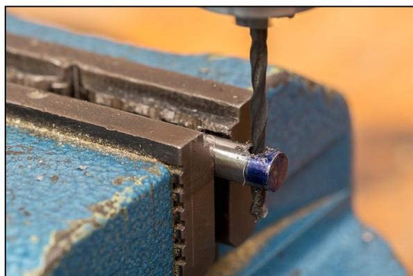
16. Mit dem Kegelsenker entgraten wir auf beiden Seiten das Bohrloch. Dadurch erreichen wir auch, dass ein Schlüsselring besser in das Loch passt. s. Abbildung unten
