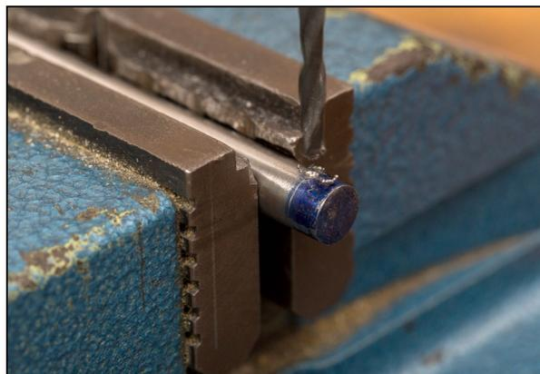
14. Zwischendurch führen wir den Senkhebel nach oben, dass die Bohrspäne abbrechen.
