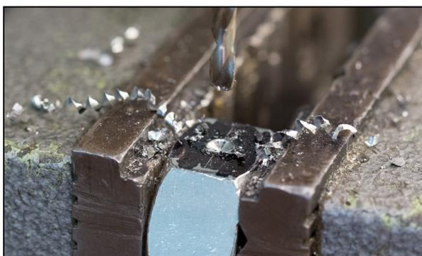
37. Kurz bevor der Bohrer die Mutter durchbohrt hat, verringern wir den Druck mit dem Senkhebel, dass der Bohrer am Innengewinde der Mutter nicht verhakt.
