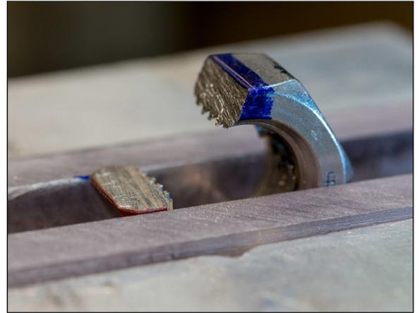
24. Zum Feilen der Flächen spannen wir die Mutter mit dem Anriss bündig zwischen zwei Kunststoff oder Hartholzleisten. Diese sollten etwas über die Schutzbacken des Schraubstocks hinausragen. Das exakte Einspannen ist schwierig und muss in Partnerarbeit erfolgen.
