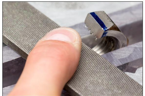
25. Mit der Flachfeile, werden so die Sägeschnitte auf das Endmaß plan gefeilt.
