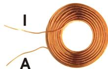
Wenn die fertig gewickelten Spulen verwendet werden, werden die Spulen so auf die Schraube gesteckt, dass die Seite der Spule, bei der der innenliegende Draht (I) nach außen geführt wird, jeweils zum Schraubenkopf zeigt. Dann wird eine U-Scheibe M8 aufgelegt und die Spulen auf den gebohrten Holzklötz geschraubt.
