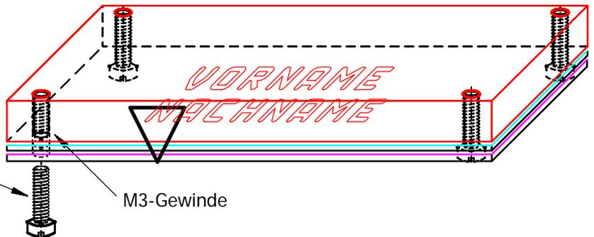
22. Alle Stirnseiten planfeilen mit einer Flachfeile, Hieb 3 u. 4 Die zusammenschraubten Teile werden zum Feilen in den Schraubstock eingespannt.
