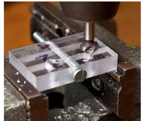
31. **Bohrlöcher entgraten** mit dem Kegelsenker. Den entstandenen Grat im Bohrloch vom Senken mit dem 5 mm Bohrer entfernen (nochmals Bohren)
