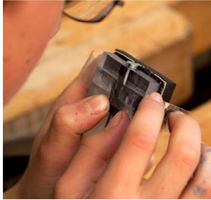
28. Von der Rückseite durch die Bohrlöcher der Grundplatte mit einem 4 mm Bohrer **die Bohrmittelpunkte des Auslegers markieren**.
