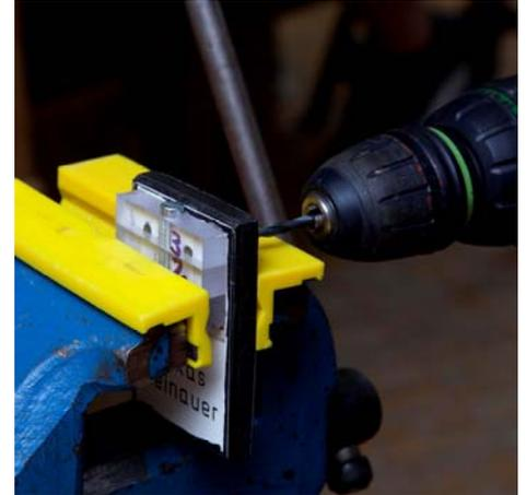
29. Klebeband entfernen und alle Teile des Auslegers zusammengeschaubt zum Bohren in den **Maschinenschraubstock einspannen**.
