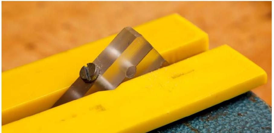
36. Gewindestecker in die Gewinde schrauben, mit Zange festziehen
