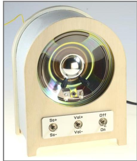
Zur Herstellung eines Schildes für die Funktion der Taster eignen sich die Resopal-Mehrschichtplatten. Gravierprogramm auf [www.ellmitron.de](http://www.ellmitron.de)
