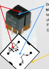
Der Empfänger ist ein sogenannter Phototransistor. Er hat nur Collector (C) und Emitter (E), die Basis ist durch eine lichtempfindliche Schicht ersetzt. Je mehr Licht auf diese Fläche fällt, desto stärker kann ein Strom von C nach E fließen.
