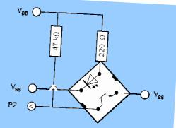
Wird die Schaltung bei größeren oder kleineren Pull-Up-Widerständen empfindlicher? Warum? Wo in dieser Schaltung befindet sich nun der Spannungsteiler?
