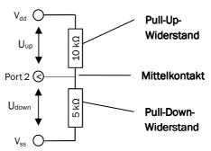
Der Pull-Up-Widerstand  $R_{up}$  und der Pull-Down-Widerstand  $R_{down}$  teilen sich die Gesamtspannung entsprechend ihrer Anteile am Gesamtwiderstand in die Spannung  $U_{up}$  und  $U_{down}$  auf. Das Potential am Port des Mikrocontrollers entspricht  $U_{down}$  und lässt sich aus den Widerstandswerten und der Gesamtspannung berechnen:
