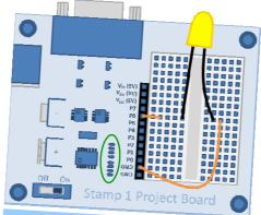
Hier ist die LED mit der Anode an Port 6 angeschlossen. Der Port wird dann abwechselnd high (5V) und low (0V), so dass die LED blinkt.
