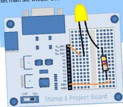
Denkt daran, die Leuchtdiode richtig herum einzusetzen (Anode ans höhere Potential) sonst kann sie von Strom nicht durchflossen werden und auch nicht leuchten.
