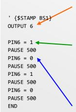
Es ist eine Besonderheit der BS1, dass jeder der Ports des Mikrocontrollers als Ausgang oder als Eingang für elektrische Signale verwendet werden kann. Hier soll Port 6 als Ausgang fungieren. Die Anweisung OUTPUT 6 sorgt dafür, dass Port 6 ein Ausgang ist.
