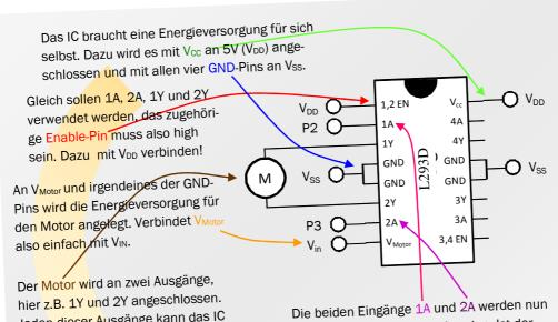
Der Motor wird an zwei Ausgange, hier z.B. 1Y und 2Y angeschlossen. Jeden dieser Ausgänge kann das IC intern entweder mit GND oder mit V<sub>Motor</sub> verbinden.
