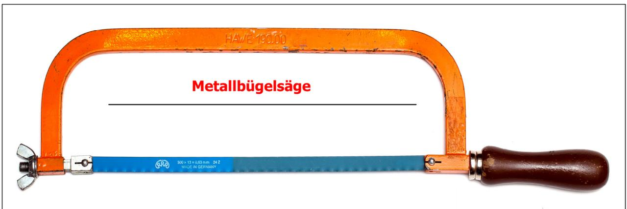
Die Metallbügelsäge arbeitet auf **Stoß**, d. h. sie wird vom Körper **weggedrückt**. Daher wird das Sägeblatt so eingespannt, dass die Zähne vom Griff **wegzeigen**!
